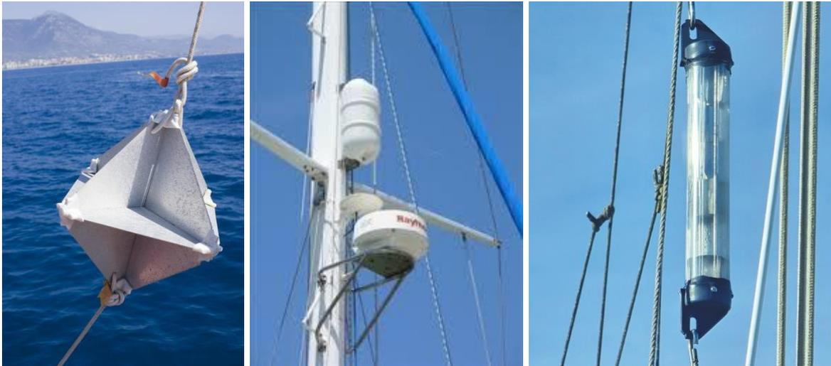
Fig 4: Distintos tipos de reflectores de radar instalados
