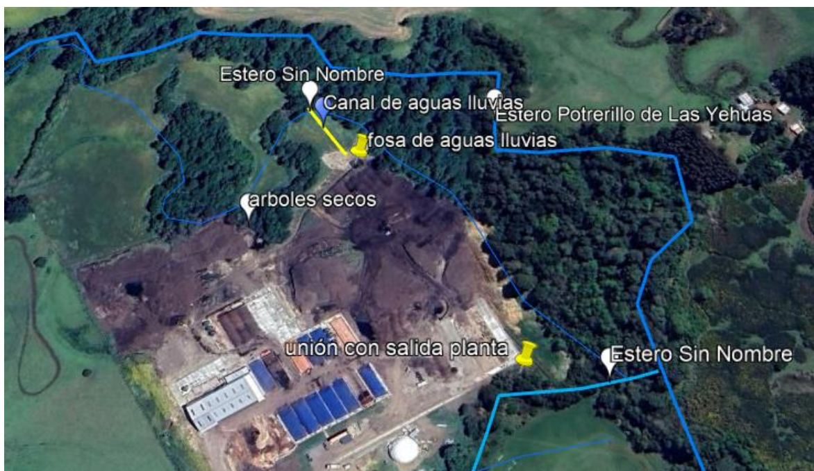
Imagen N°6: tramo de canalización de aguas lluvias (en línea amarilla) que evacua en el estero sin nombre y éste al estero Potrerillo de Las Yeguas (en línea azul).
