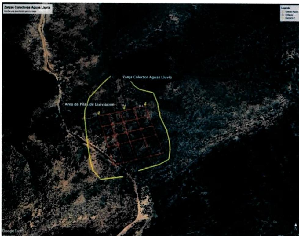
Estas son unas zanjas colectoras de aguas lluvia que circundan toda el área de pilas, deben tomar todas las corrientes de las pequeñas quebradas para evitar que aguas entren al sistema y puedan ser conducidos aguas abajo.
